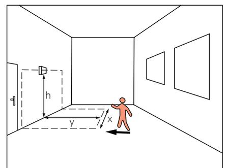
Durchmesser des Erfassungskegels in Abhängigkeit der Höhe bei max. eingestelltem Erfassungsbereich ohne Berücksichtigung im Raum befindlicher Objekte. Stationäre Objekte (Wände, Tische, Stehleuchten, ...), die sich im direkten Sichtfeld des Sensors befinden, verändern die Charakteristik des Erfassungsbereichs. Die angegebenen Werte sind typische Werte, je nach Umgebung und Anwendung kann sich der Erfassungsbereich verändern.
